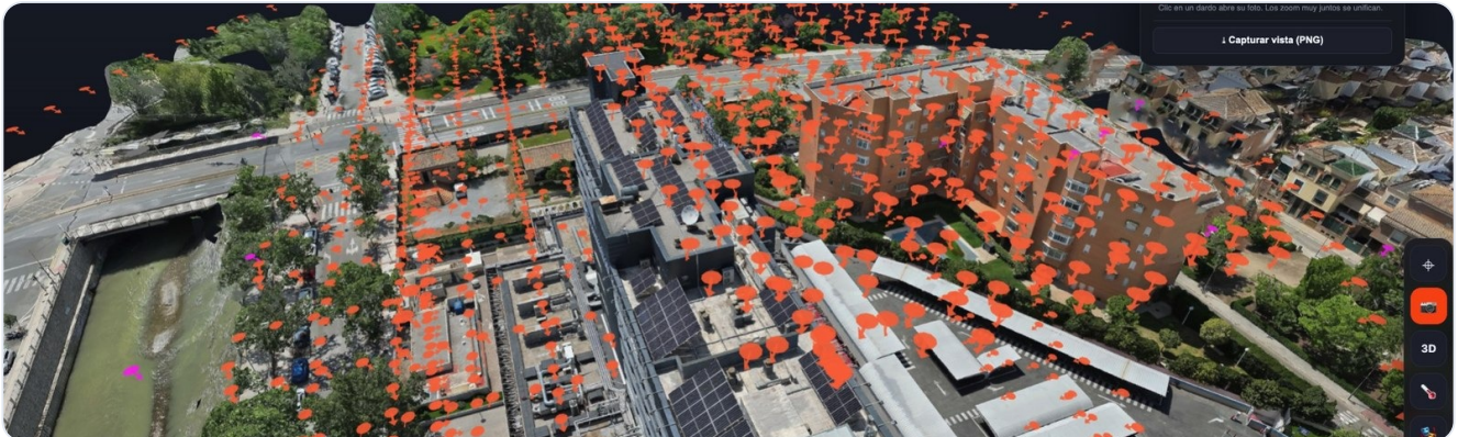
El gemelo digital 3D y la red de posiciones de cámara del vuelo de inspección.
